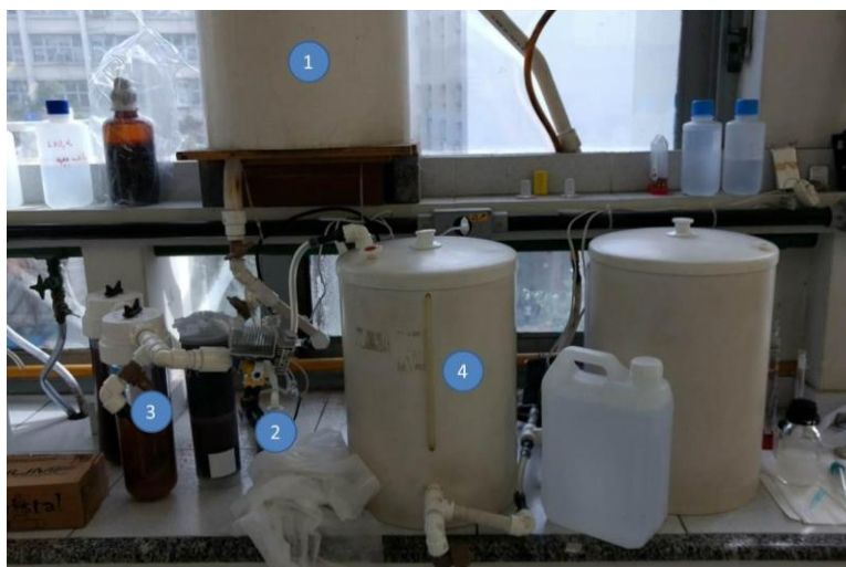
Fig. 1 - Sistema piloto: 1-Decantação; 2-Lâmpada UV; 3-Deionizador; 4-Armazenamento Fonte: foto do autor.
