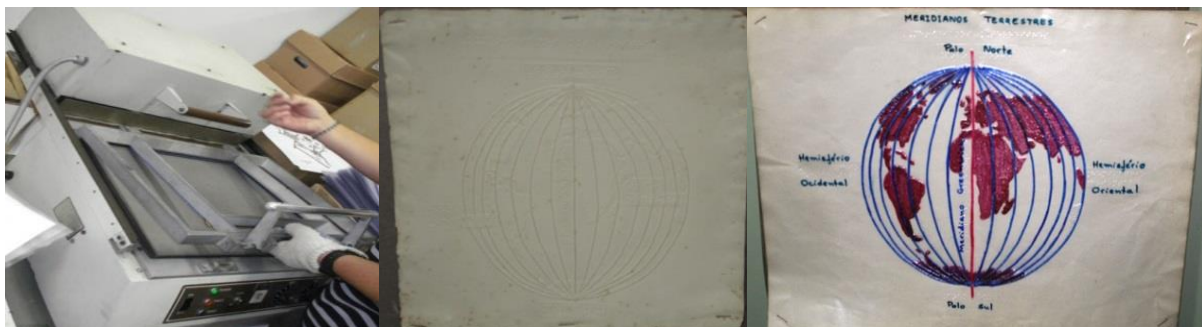
Figura 7 - Máquina de thermoform; Mapa tátil original; Mapa tátil pintado. Fonte: ARRUDA, L. M. S, 2019.
