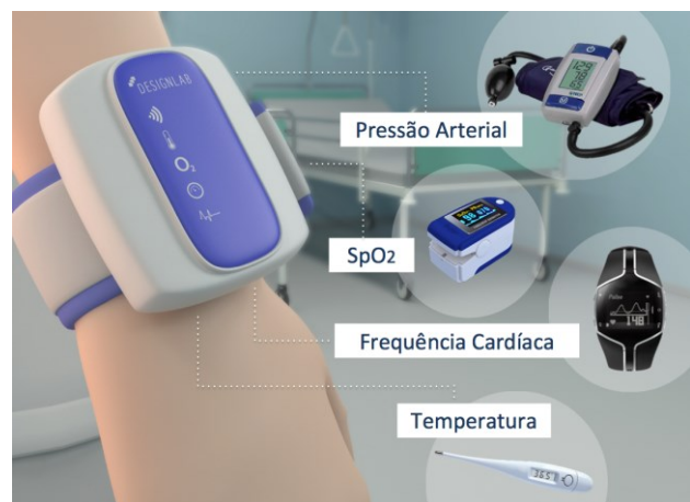
Figura 3 – Modelo conceitual para a Pulseira Multiparamétrica. Fonte: Elaborada pelos próprios autores.
