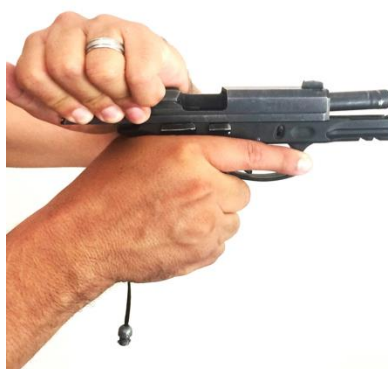
Figura 9: Exemplo de usuário realizando o puxamento do ferrolho para preparo e efetuação do disparo.
