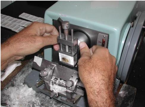
Figura 2: Micrótomo rotativo American Optical 820.
