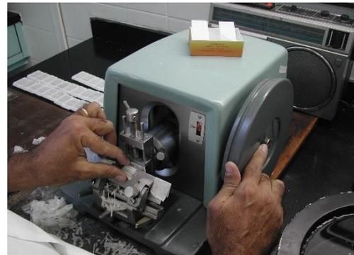
Figura 4: Processo de microtomia
