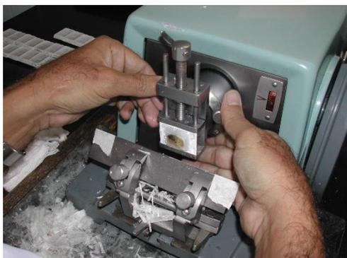
Figura 3: Detalhe do ajuste do bloco no aparelho.
