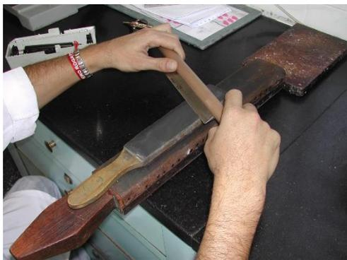
Figura 6: Amolagem da navalha
