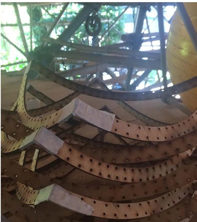
*Figuras 6, 7 e 8: Modelos de experimentação de dupla curvatura com fibras naturais no LILD. Design e produção por Elvert Durán Vivanco.*
