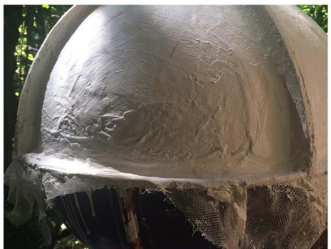
*Figuras 2, 3, 4 e 5: Modelos de experimentação de dupla curvatura com fibras naturais no LILD. Design e produção por Elvert Durán Vivanco.*
